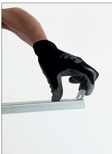
Загніть кінець розпірної планки та відкрутіть гвинт з нижньої частини кріплення.
