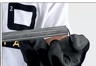
Загніть кінець розпірної планки та відкрутіть гвинт з нижньої частини кріплення.
