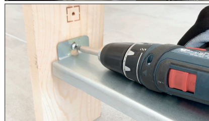
Розташуйте розпірну планку: закріпіть її за допомогою відповідного отвору в пеналі, з іншого боку закріпіть до стійки гвинтом.
